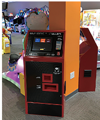
リデンプションのポイントも記憶できるゲームカード販売端末。カードに現金をチャージして使用する
